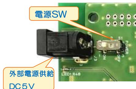
対応する AC アダプタ DC プラグ：2.10mm 内径、5.50 外径 (PL03B)
